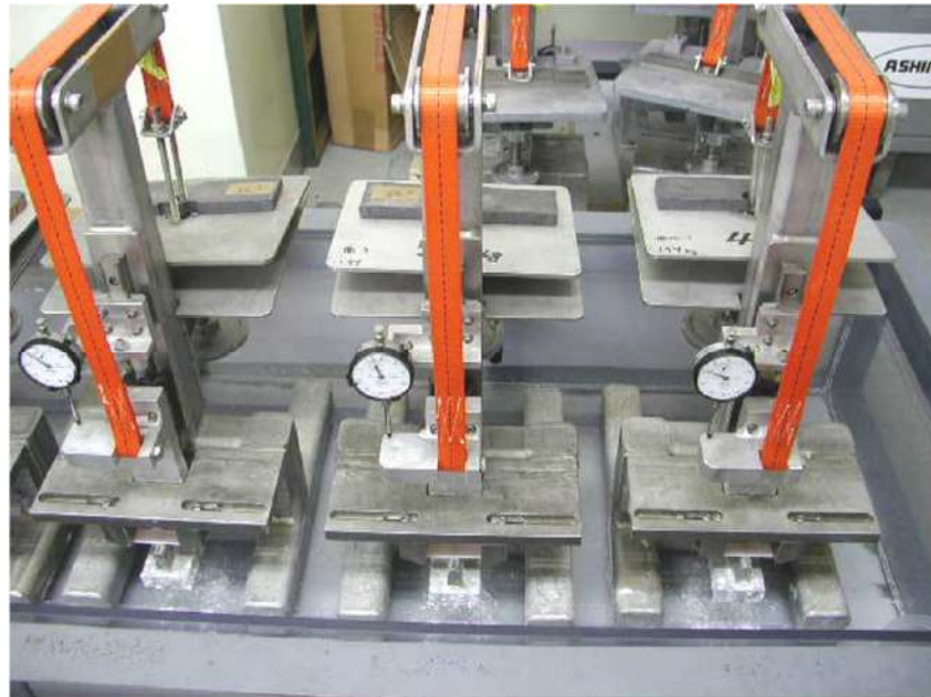
写真 4-10 曲げクリープ試験状況
