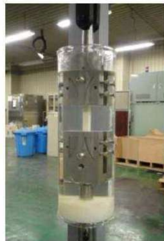
写真 4-13 引張りクリープ試験状況
