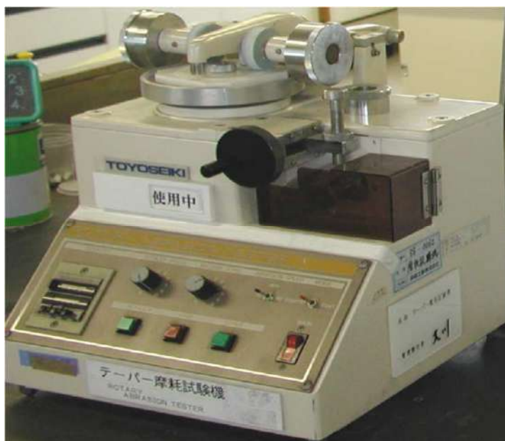
写真 4-8 耐摩耗性試験状況
