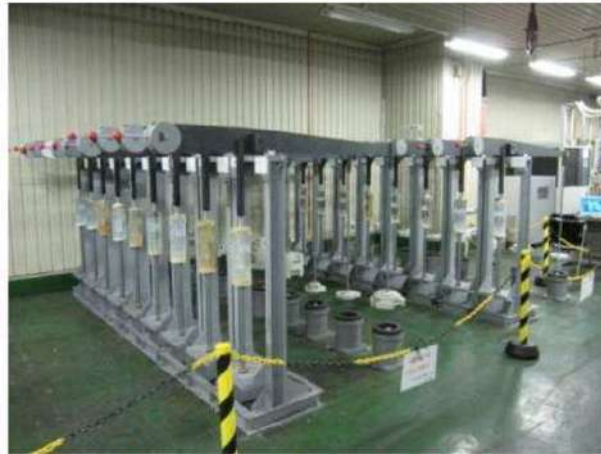
写真 4-13 引張りクリープ試験状況
