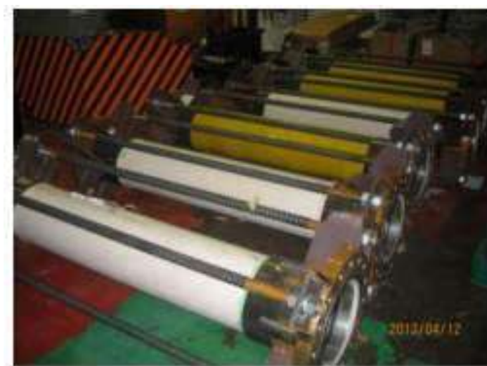
写真 4-3 内水圧試験体
