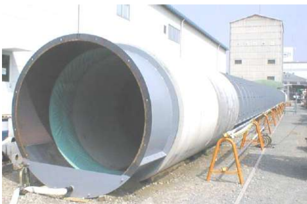
写真 13-1-1 施工性の確認試験用配管
