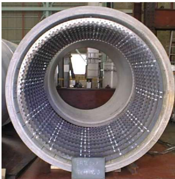
写真 9-2-5 呼び径 2,000 更生管
