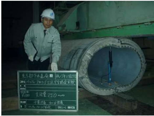
写真 15-4 250 mm 変位時状況（オス側）
