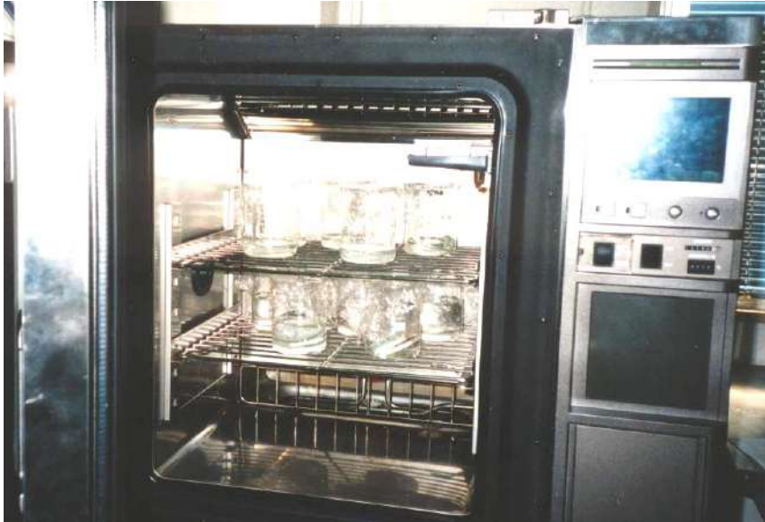
写真 8-2-1 耐薬品性試験状況
