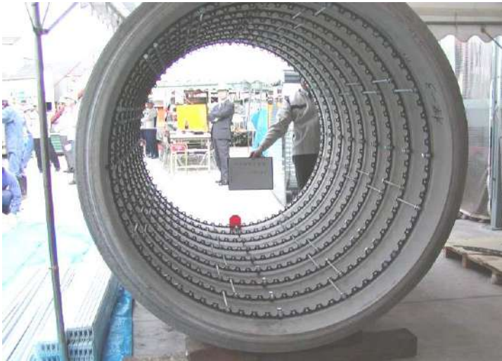
写真 13-4-2 鋼製リング高低差確認（実測値 19 mm）
