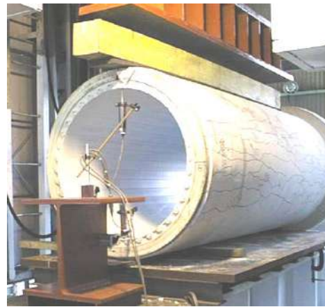
写真 9-1-2 呼び径 800 外圧試験
