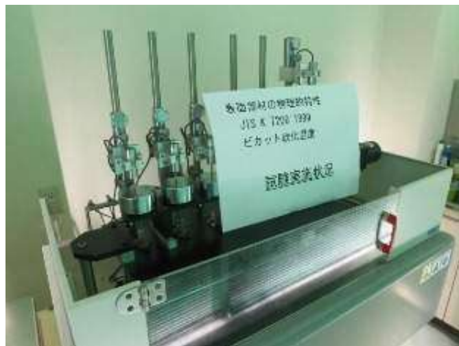
写真 8-4-1 ビカット軟化温度試験状況
