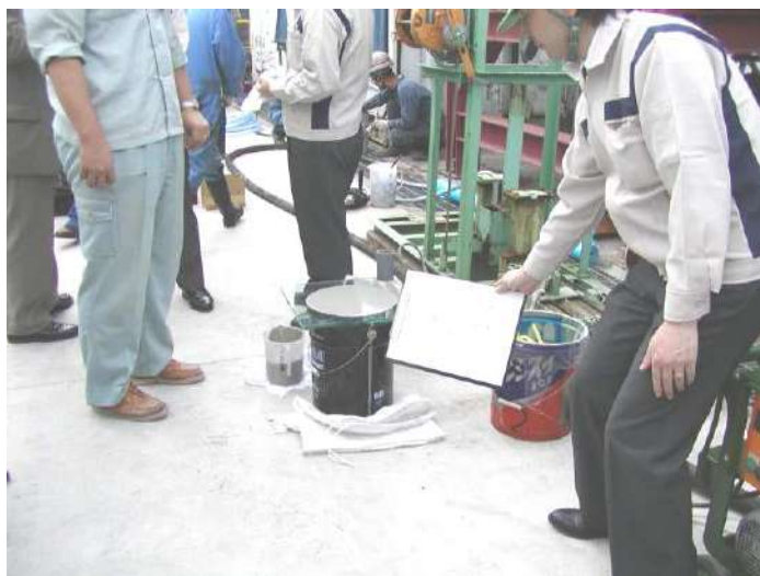
写真 13-3-1 フロー値の測定 ( 304 mm × 303 mm)
