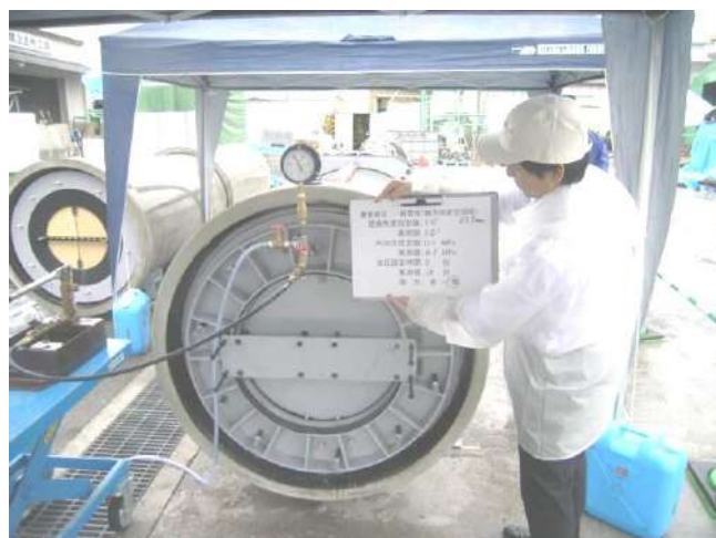
写真 14-1 継手部の軸方向変位と屈曲 1.0 ° の内水圧試験状況
