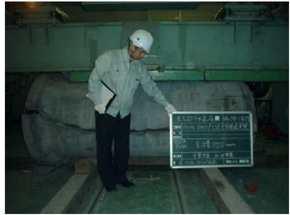
写真 15-5 250 mm 変位時状況（側面）
