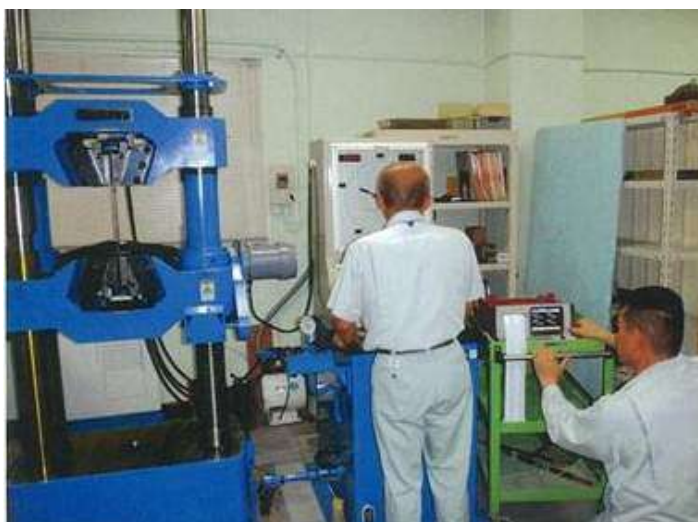
写真 17-1 鋼製リングの引張試験状況
