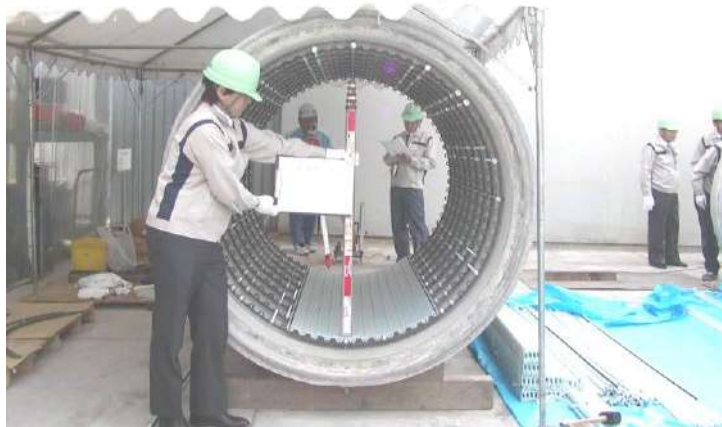
写真 13-4-3 更生管の高低差確認（実測値 19 mm）
