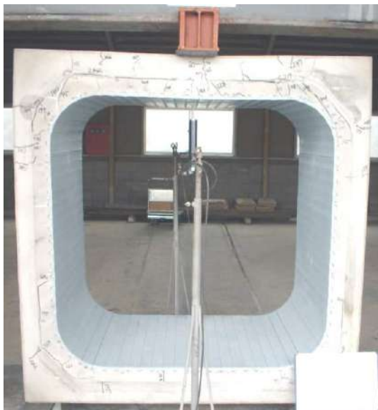
写真 9-3-16 40 mm 減肉全面更生管の外圧試験状況
