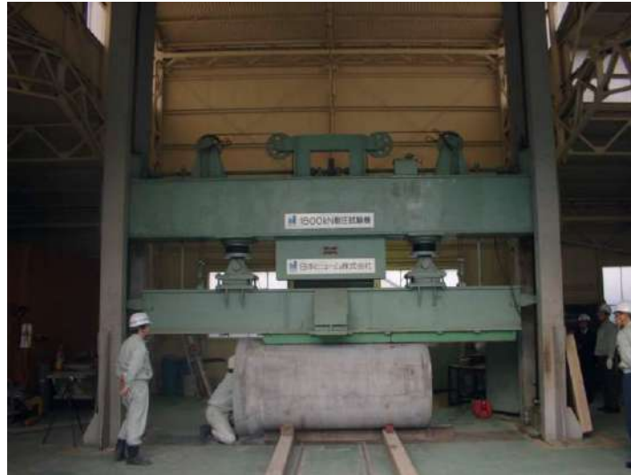
写真 15-1 完全破壊試験 試験全景
