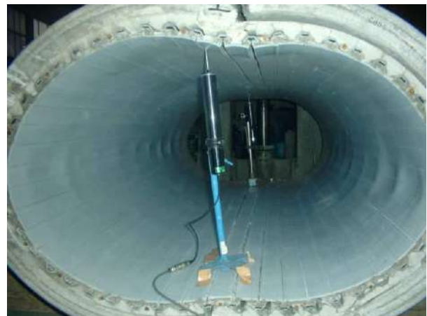
写真 15-3 250 mm 変位時状況 (メス側)
