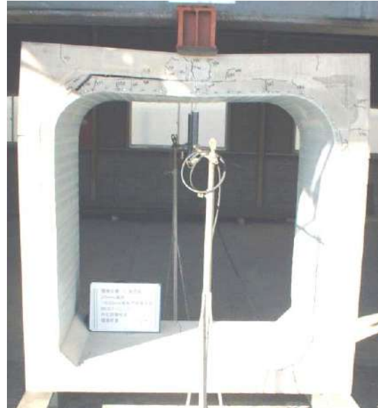
写真 9-3-15 25 mm 減肉門形更生管の外圧試験状況
