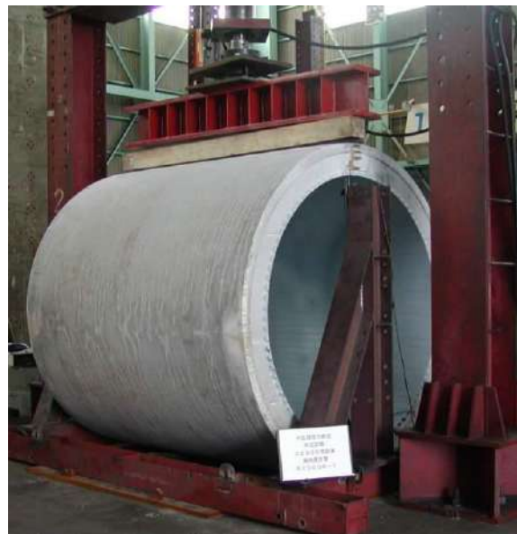
写真 9-2-6 呼び径 2,000 外圧試験
