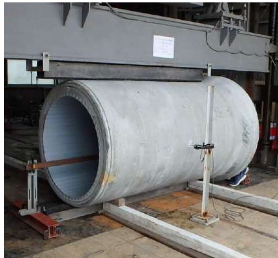
写真 9-2-4 呼び径 1,200 外圧試験
