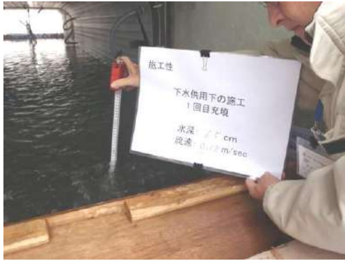
写真 13-5-18 水深・流速測定状況
