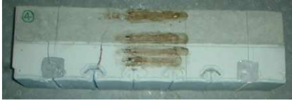
写真 12-3-7 複合体の界面状況 (フローリングモルタル1号)
