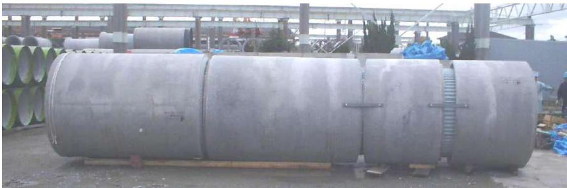
写真 13-2-1 円形管継手部の施工性試験配管
