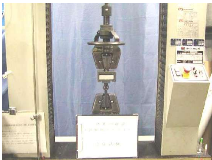
写真 12-1-1 充填材の接着強さ試験状況（タイプ 1）
