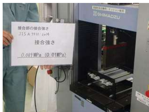
写真 18-1 接合部の接合強さ試験状況
