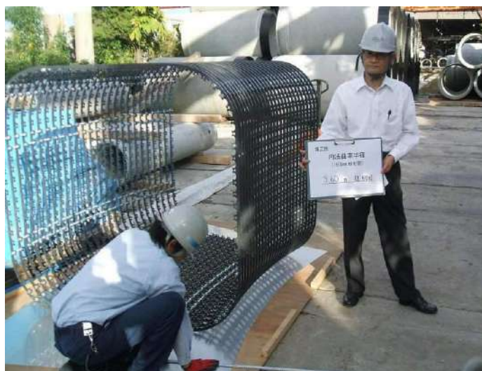
写真 13-2-22 1,500 mm 矩形管 内法曲率半径測定状況
