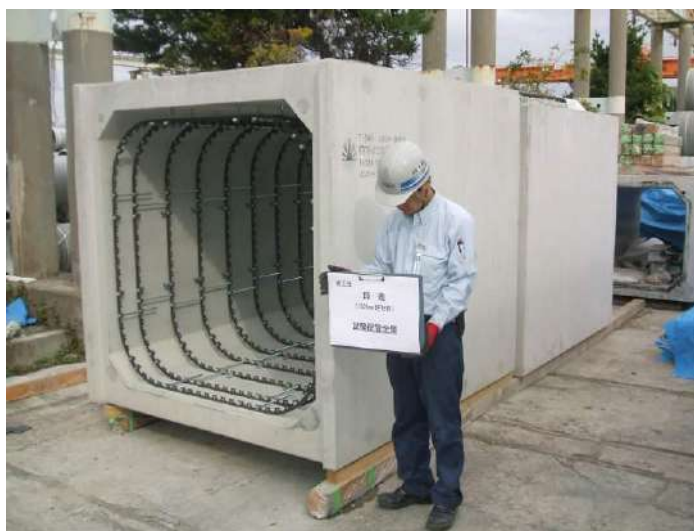
写真 13-2-13 矩形管段差部の施工性試験配管
