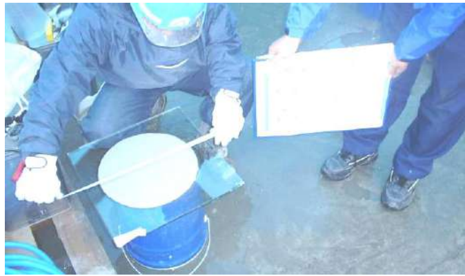
写真 13-3-4 フロー値の測定 ( 295 mm × 295 mm)
