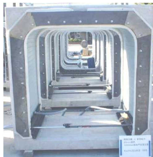
写真 9-3-11 25 mm 減肉門形更生管の充填材注入状況
