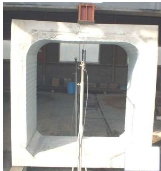
写真 9-3-17 40 mm 減肉門形更生管の外圧試験状況
