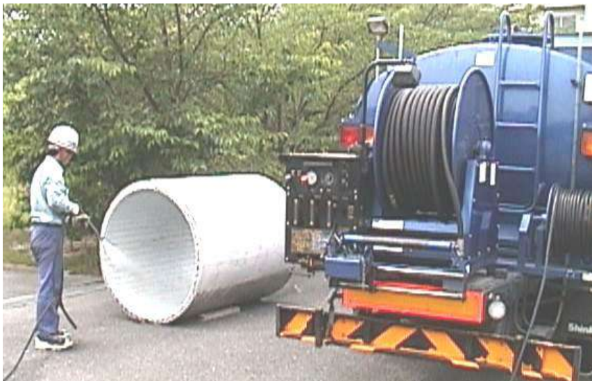
写真 8-6-1 高圧洗浄試験状況
