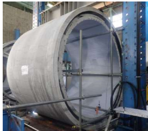
写真 9-1-4 呼び径 3,000 外圧試験
