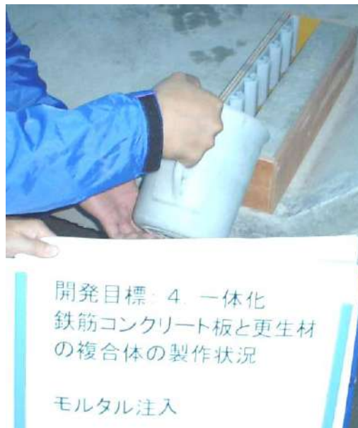
写真 12-3-1 試験体の製作状況（充填材注入）
