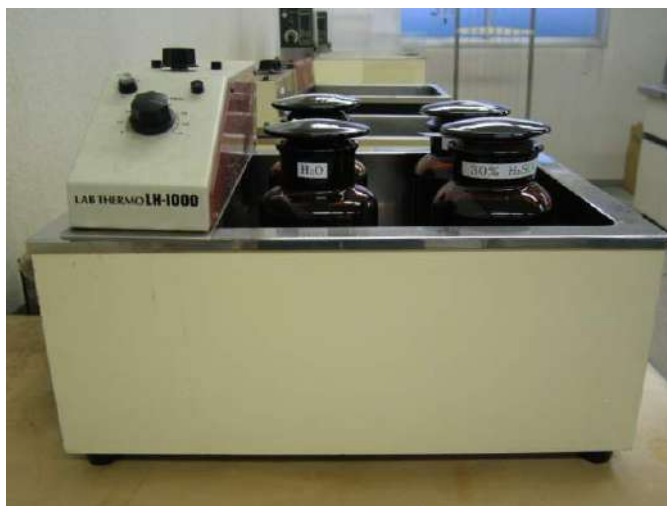
写真 2 耐薬品性試験状況
