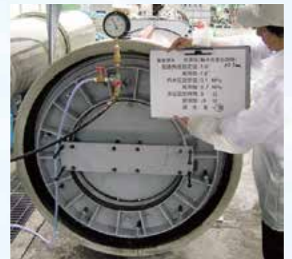
漏水確認状況
