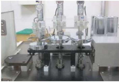
写真 46 負荷時のたわみ温度試験状況 (樹脂平板)
