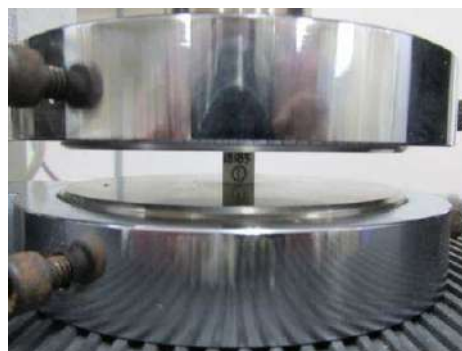
写真 34 圧縮強さ測定状況
