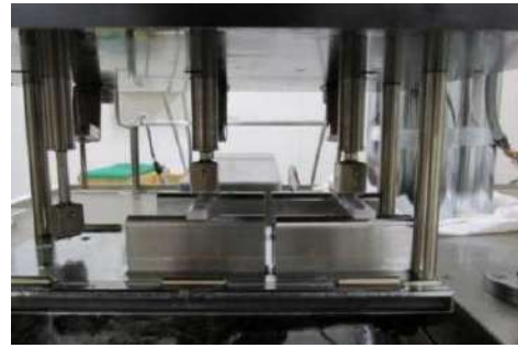
写真 47 負荷時のたわみ温度試験状況 (樹脂平板)
