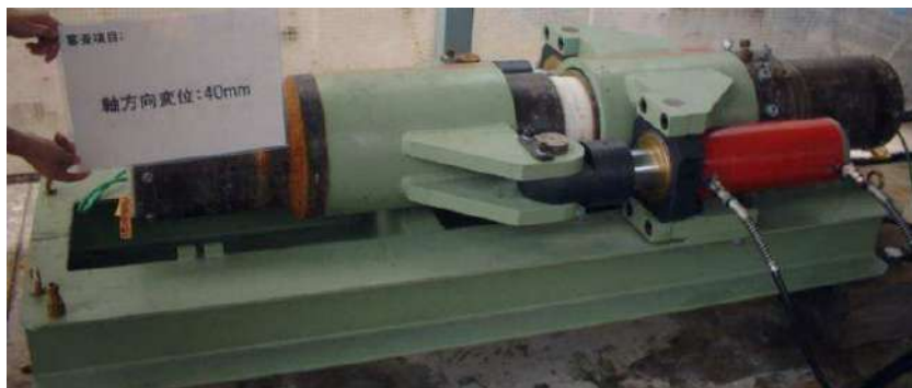
写真 54 軸方向変位量確認
