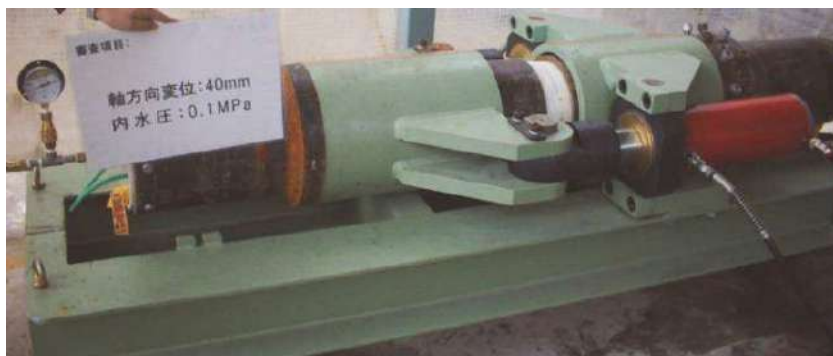
写真 55 最大軸方向変位量での水密性確認
