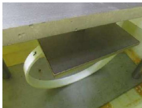
写真 7 長期曲げ強さ試験载荷状況
