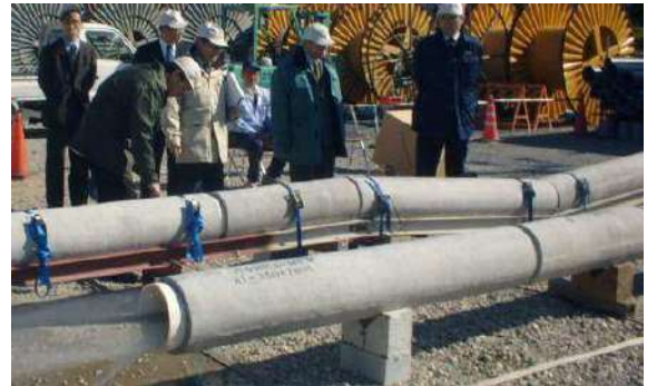
写真 49 耐高圧洗浄性試験状況
