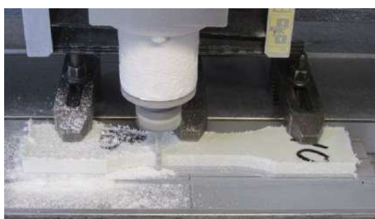
写真 29 引張試験片切り出し状況
