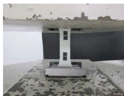
写真 32 引張強さ、引張伸び率測定状況
