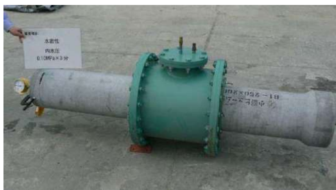
写真 25 内水圧試験装置
