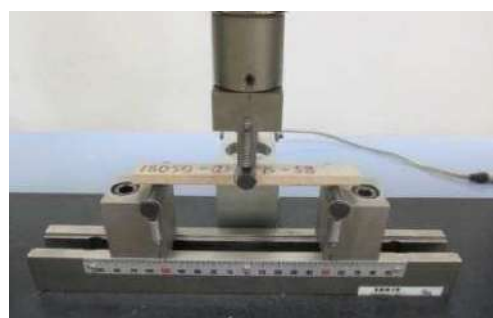
写真 17 曲げ試験状況(硫酸 60℃、1年浸漬後)
