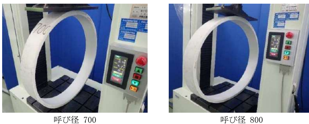
写真 2 外圧強さ測定試験
