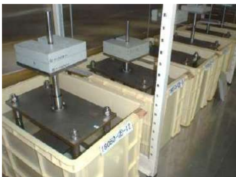
写真 6 長期曲げ強さ試験実施状況
