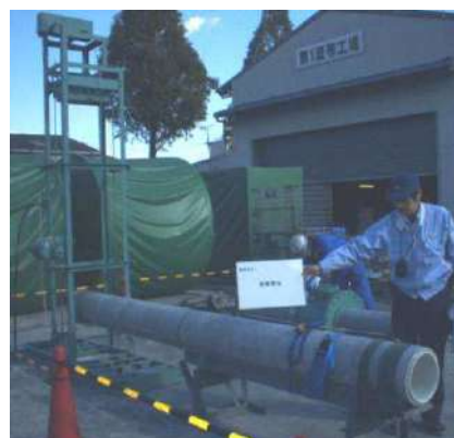
写真50 耐衝撃性試験状況
