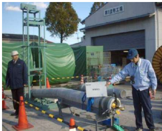
写真 52 耐衝撃性試験状況(内水圧 0.10MPa)
