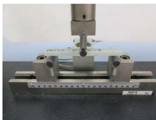
写真 15 曲げ試験状況(蒸留水 28 日浸漬後)
