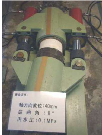
写真 56 軸方向変位量と屈曲角作用後の水密性確認
