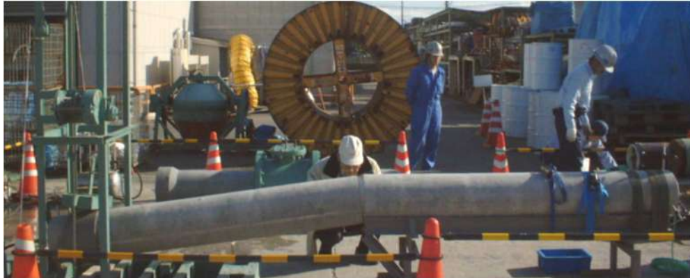
写真 51 耐衝撃性試験状況
