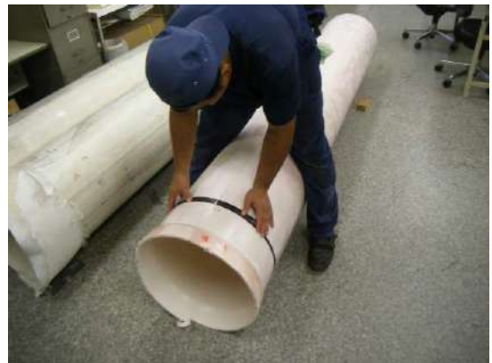
写真 2 1 内径方向寸法確認状況
