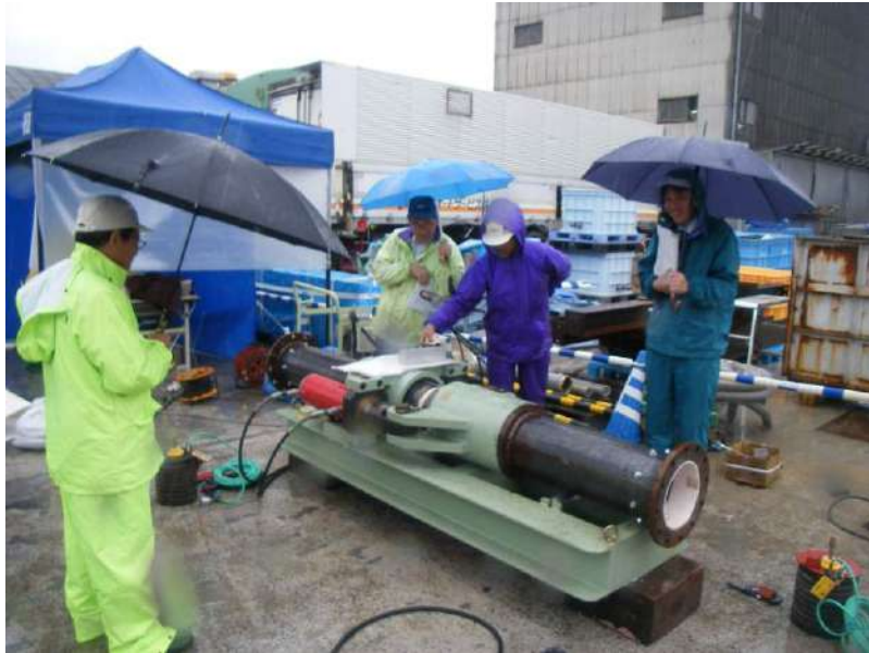
写真 12 地盤追従性試験状況
