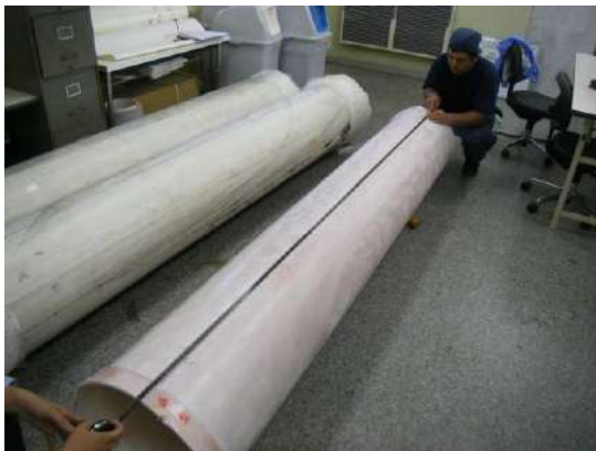
写真 2 0 軸方向寸法確認状況
