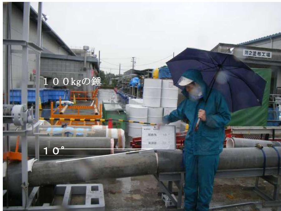
写真10 10°屈曲させた状況
