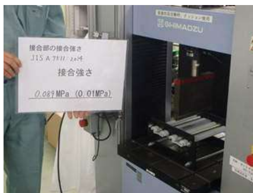
写真 18-1 接合部の接合強さ試験状況
