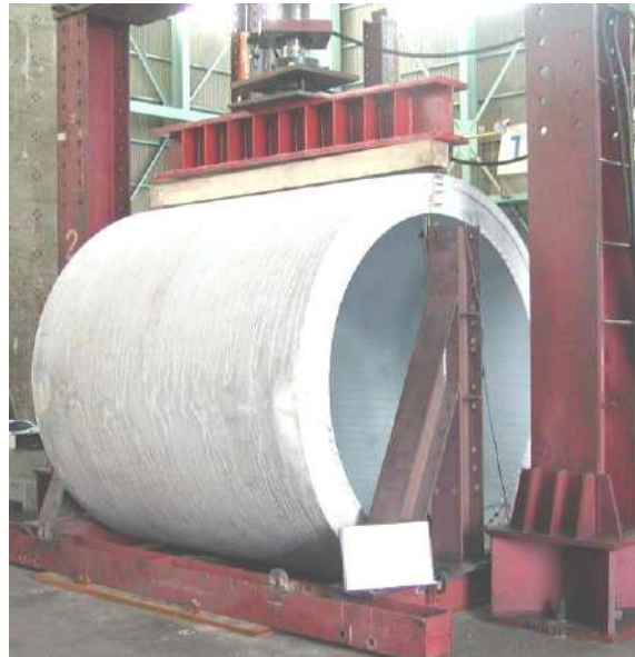
写真 9-2-4 呼び径 2,000 外圧試験
