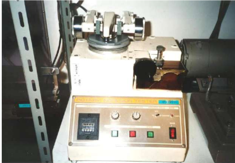
写真 8-3-1 耐摩耗性試験状況
