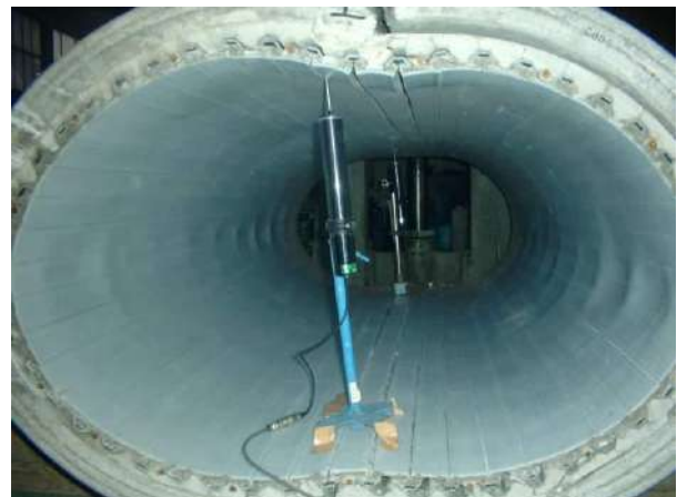
写真 15-3 250 mm 変位時状況（メス側）
