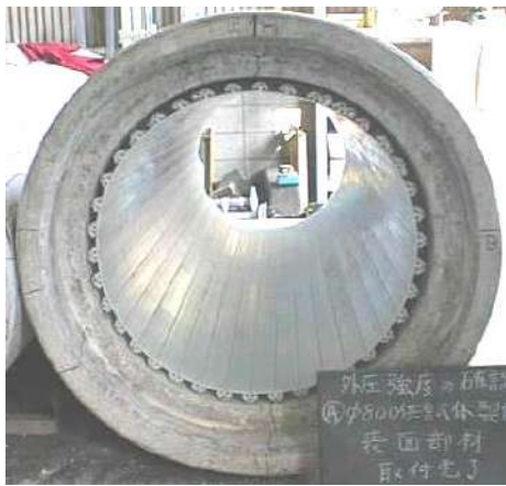
写真 9-1-1 呼び径 800 更生管
