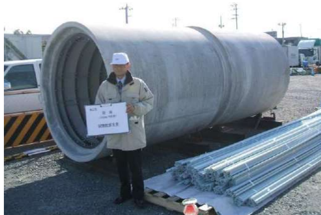
写真 13-2-2 円形管段差部の施工性試験配管
