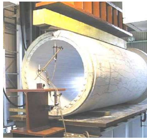
写真 9-1-2 呼び径 800 外圧試験
