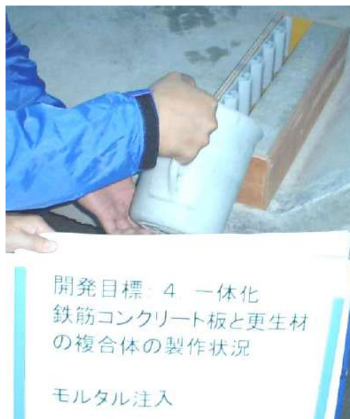
写真 12-3-1 試験体の製作状況（充填材注入）
