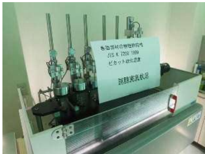
写真 8-4-1 ビカット軟化温度試験状況
