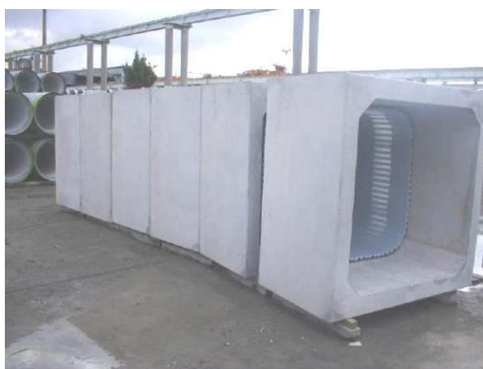
写真 13-2-12 矩形管継手部の施工性試験配管
