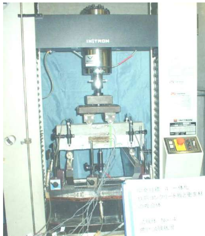
写真 12-3-3 コンクリート板と更生材の複合体曲げ試験状況
