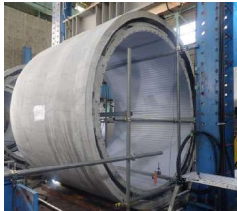
写真 9-1-4 呼び径 3,000 外圧試験
