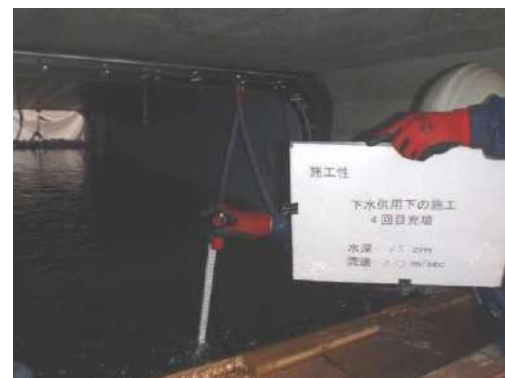
写真 13-5-23 水深・流速測定状況
