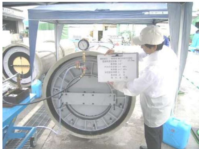
写真 14-1 継手部の軸方向変位と屈曲 1.0^\circ の内水圧試験状況
