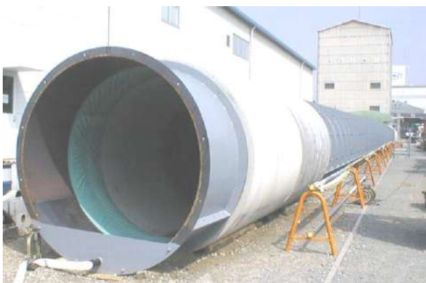
写真 13-1-1 施工性の確認試験用配管
