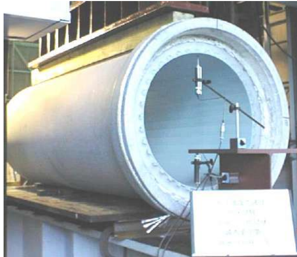
写真 9-2-2 呼び径 800 外圧試験
