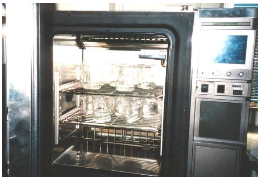
写真 8-2-1 耐薬品性試験状況
