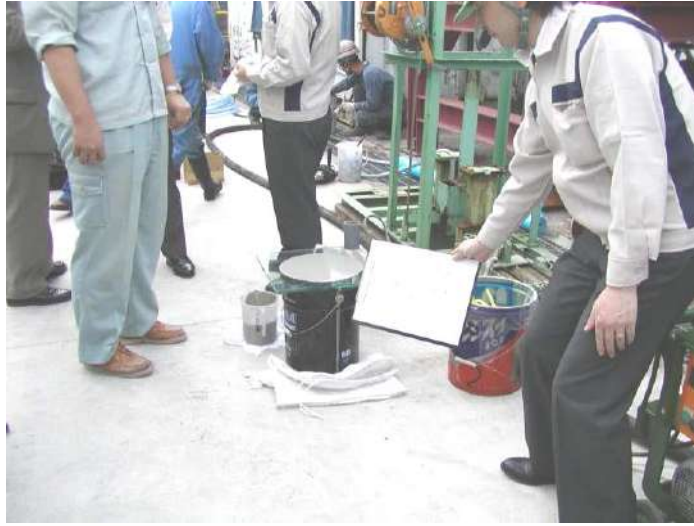
写真 13-3-1 フロー値の測定 ( 304 mm × 303 mm)
