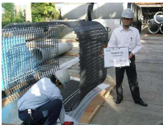
写真 13-2-22 1,500 mm 矩形管 内法曲率半径測定状況
