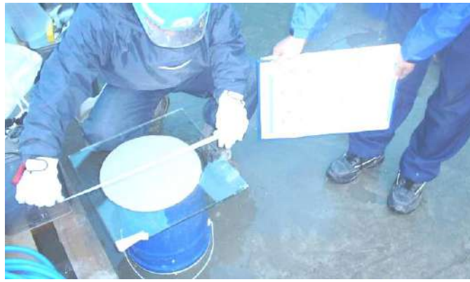
写真 13-3-4 フロー値の測定 ( 295 mm × 295 mm)
