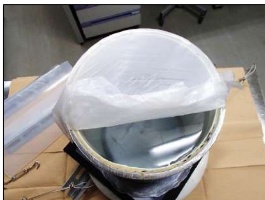
写真 8-8 浸出液充てん状況
