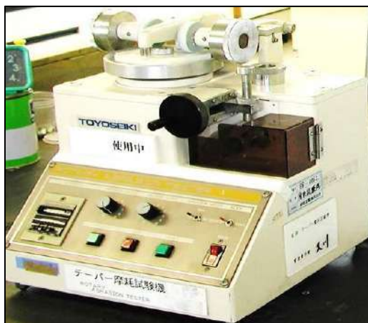
写真 2-1 耐摩耗試験状況
