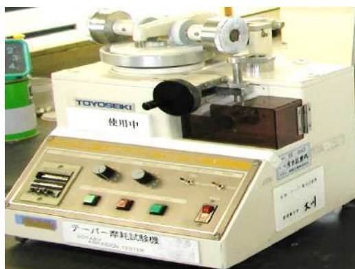
写真 2-1 耐摩耗試験状況
