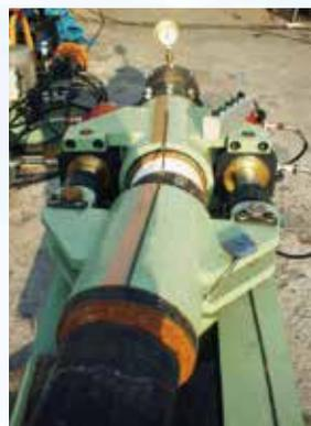
地震時には管路に引張単独や屈曲単独の力が作用するのではなくて複合した力が作用します。そこで、更生管に引張と屈曲を同時に作用させ、その状態で漏水がないことを確認し、SZパイプが地盤変位に伴う既設管への追従性を有することを確認しました。
