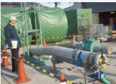
2mの高さから100Kgの錘を更生管に落下させ、更生管継ぎ手部を10°屈曲させた状態で0.1MPaの内水圧を3分間作用させ、漏水箇所がないことから、SZパイプの耐衝撃性を確認しました。
