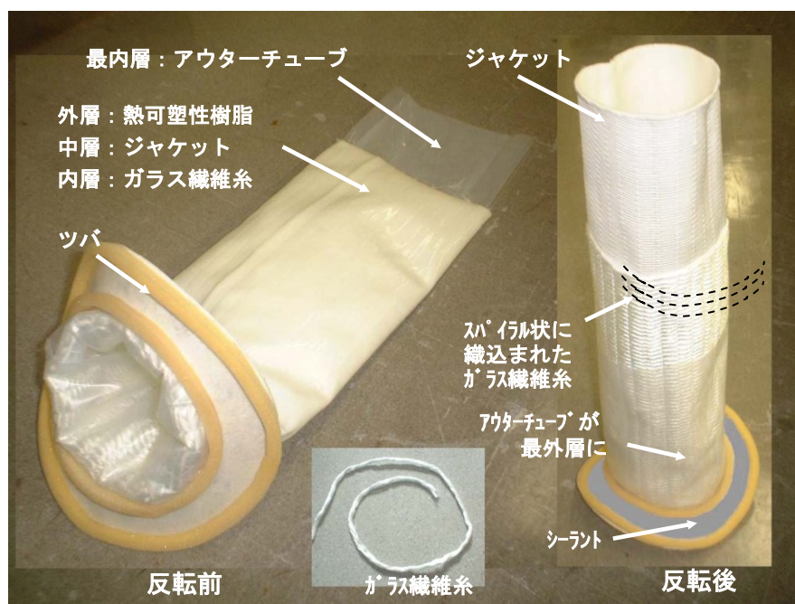
写真 1 シールホース PA-B の構造
